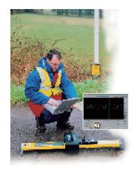
SCM杂散电流测绘系统是世界上最先进的管道杂散电流检测的专用设备。与SI智能信号发送器配合, SCM可对杂散电流进行识别和检测。适用于预备性测量,工程技术测量,防护效果评定,运行工况监测中杂散电流的测量。
